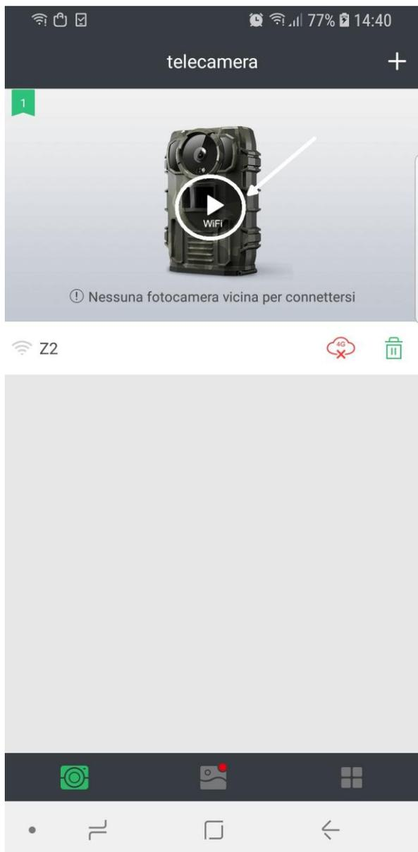
Cliccando sul pulsante a forma di triangolo con la **scritta "WiFi"** indicato dalla freccia si aprirà l'anteprima dell'immagine in diretta sulla fototrappola tramite, appunto, la connessione WiFi.
