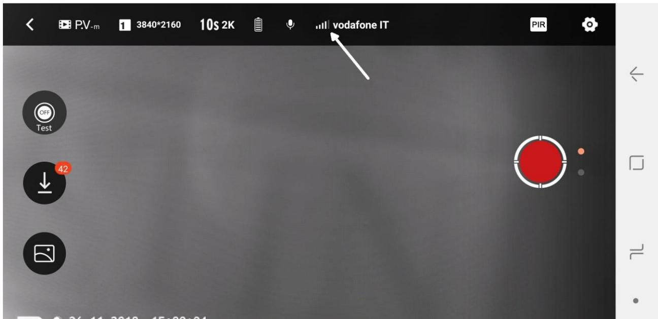
Quando si è collegati alla fototrappola in modalità Wi-Fi, nella barra in alto è possibile vedere che il collegamento 4G è attivo perché comparirà il simbolo della connessione con il numero di tacche relative alla potenza del segnale e il nome dell'operatore in uso sulla scheda SIM presente nel modulo 4G della fototrappola.
